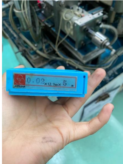
Imagen 49. Grosor de Lainas que utilizamos
