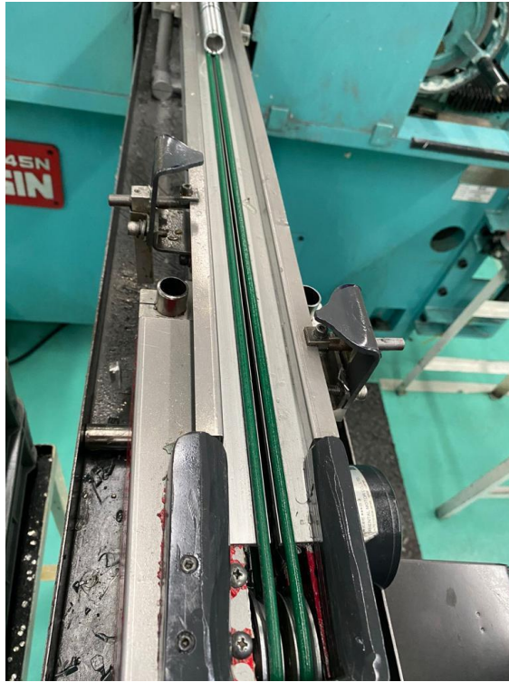
Imagen 60. Banda transportadora cambiada
