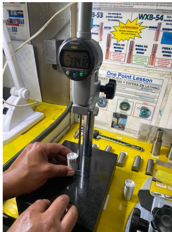
Imagen 46. Chequeo de orificio
