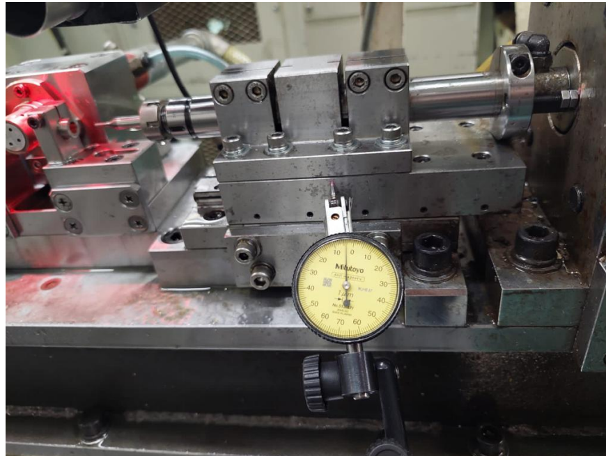
Imagen 52. Chequeo de Concentricidad del carrito
