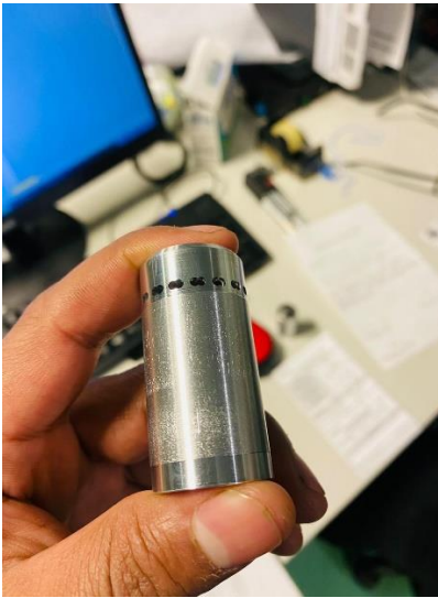
Imagen 22. Pistones con doble punch
