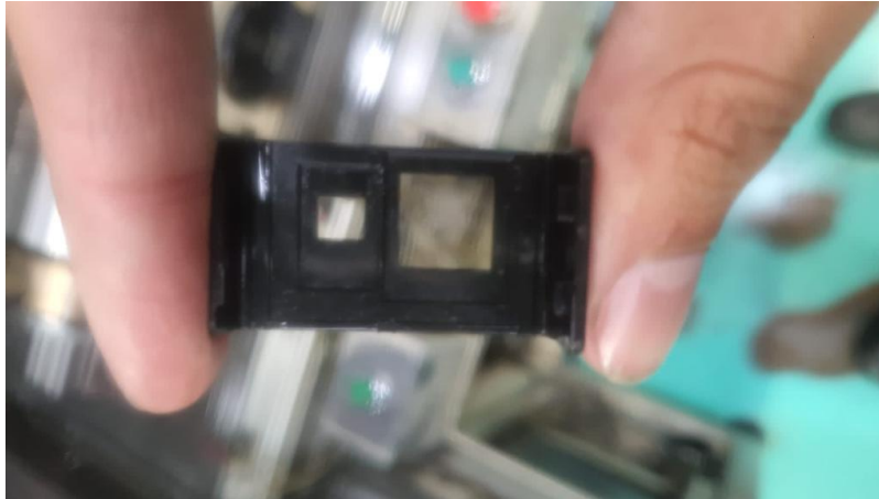
Imagen 23. Mica del sensor sucia
