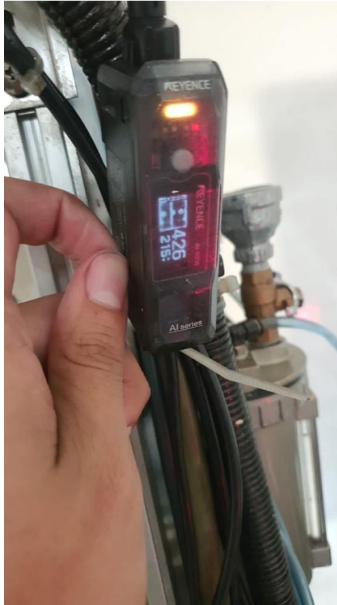
Imagen 54. Chequeo de detección de pieza
