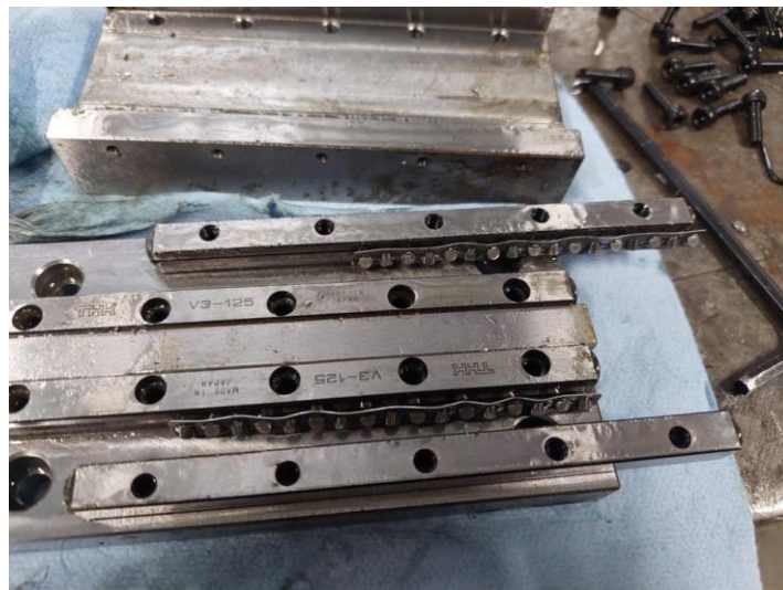
Imagen 20. Rieles en mal estado
