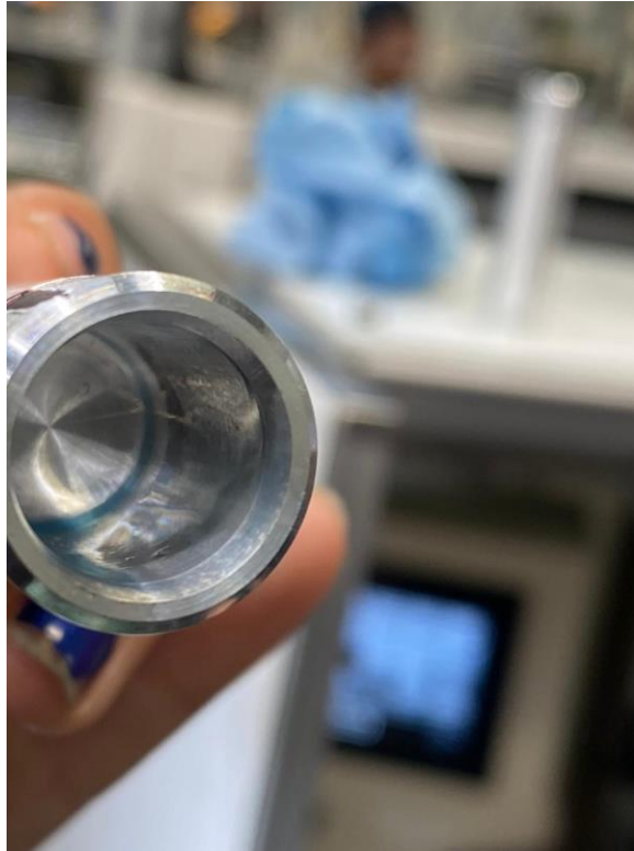
Imagen 41. Pieza con marcas en el interior
