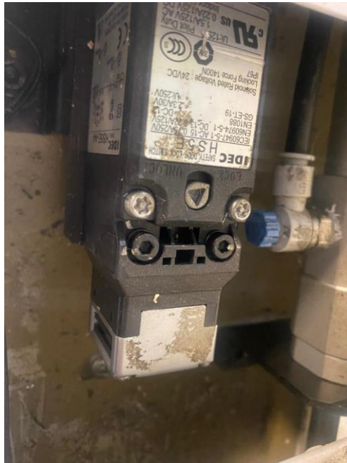
Imagen 27. Sensor flojo por la vibración
