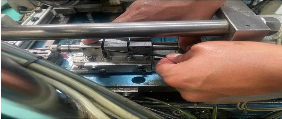
Imagen 47. Extracción de la placa lateral de la puntas
